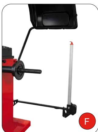
FR TE-D Détecteur externe pour la mesure de la largeur de roue (en option uniquement pour version TECO 6600A)
